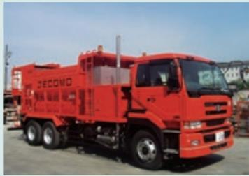
連続練りミキサーを搭載した大型の移動式コンクリートミキシングシステム。高品質な超速硬コンクリートをいつでもどこでも供給可能です。1時間あたりの供給能力は5~10m³です。繊維補強タイプも供給可能です。
